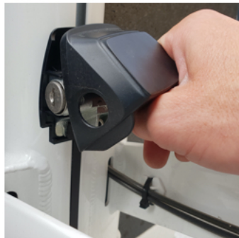
1.3 Klik de slotkap los door deze voorzichtig iets naar de zijkanten open te buigen.
