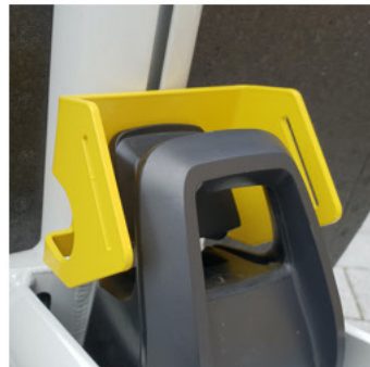
2.2 Klik de accu in de fiets en stel indien nodig het slot goed af.
