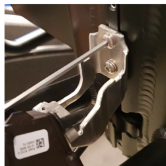
2.4 Schroef de beugel los met een Inbus sleutel.
