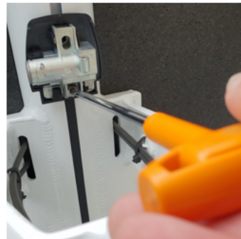
1.4 Schroef de twee Inbusbouten los.
