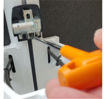
1.4 Schroef de twee Inbusbouten los.
