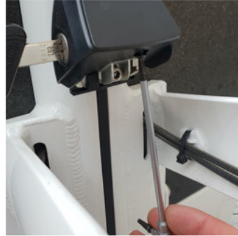
1.2 Schroef de slotkap aan de onderkant los met een Torx schroevendraaier.
