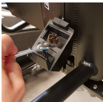
2.1 Schroef de twee delen van de behuizing los met een Torx schroevendraaier.
