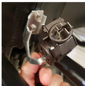
2.3 Maak de connector los van de beugel.
