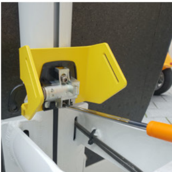
2.1 Monteer de Lockride beugel, draai de bouten nog niet helemaal vast.
