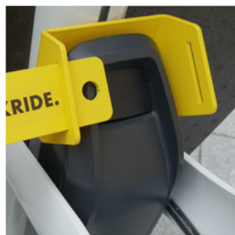
2.5 Schuif de pin in de beugel en zet deze opslot door middel van een discus- of hangslot.
