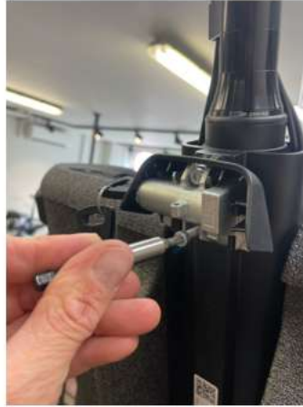
1.3 Nu kan je het kapje loshalen en de bouten van het Bosch slot losschroeven.
