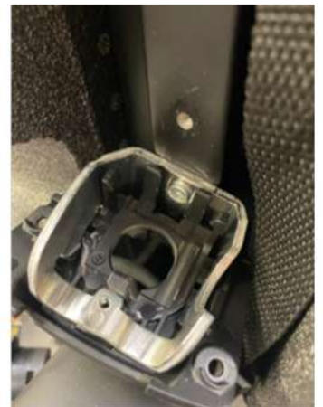
2.4 Schroef hierna de beugel los en haal deze van het frame af.
