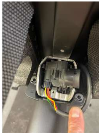
2.3 Klik de kabel los van de klem zodat je de connector uit de metalen beugel kunt wippen.
