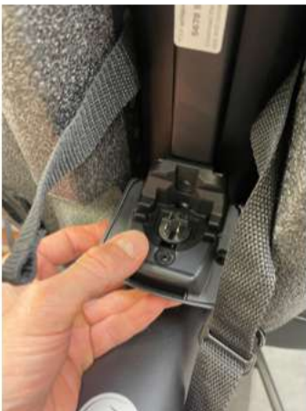
2.1 Schroef het kunststof kapje van de behuizing los.
