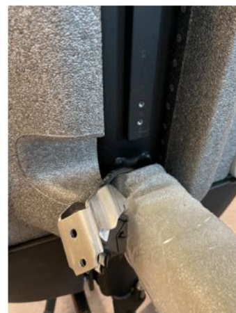
2.4 Schroef de beugel los met een Inbus sleutel.
