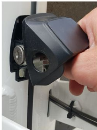
1.3 Klik de slotkap los door deze voorzichtig iets naar de zijkanten open te buigen.
